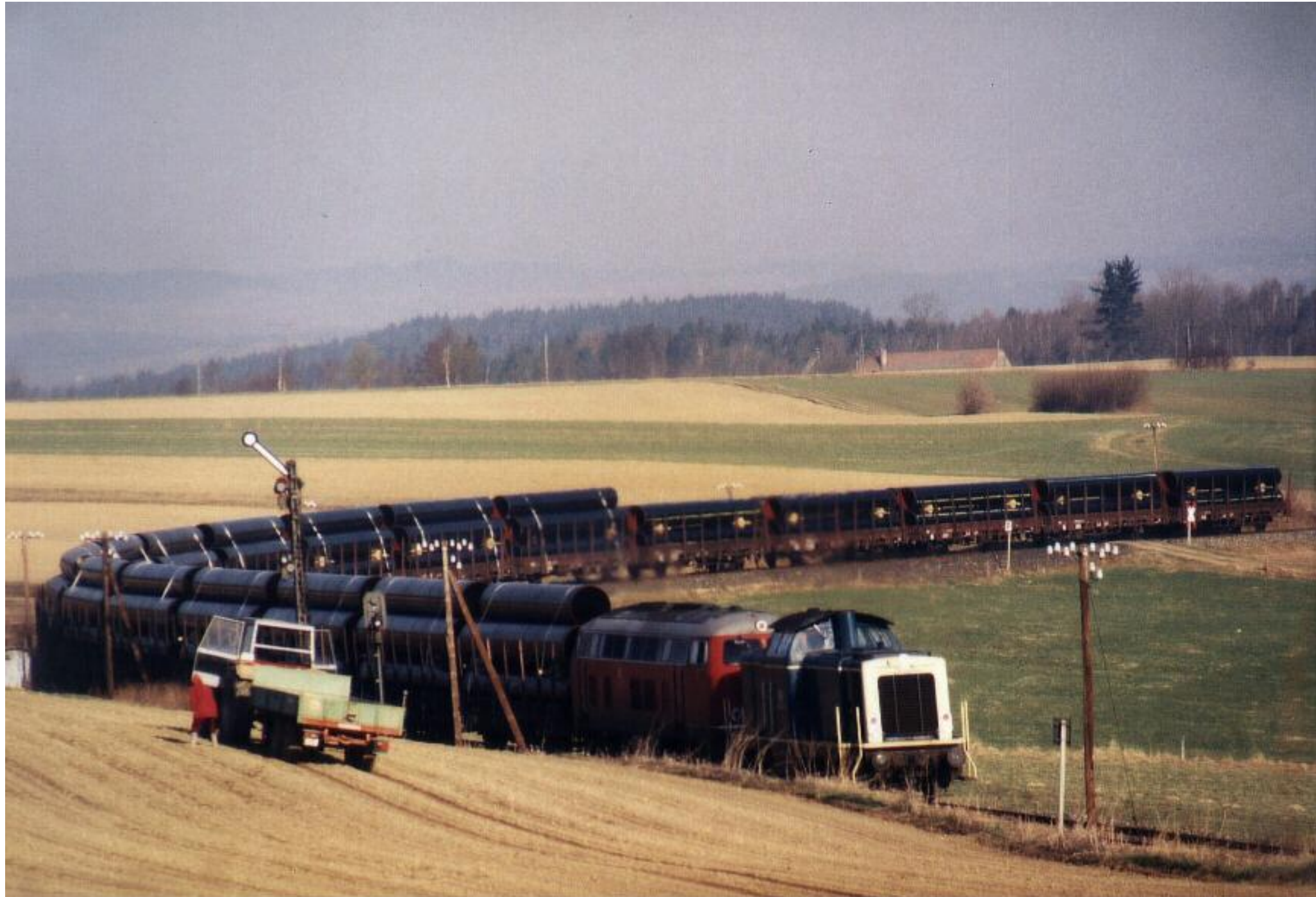
Am Vormittag des 16. April 1986 lichtete Gerald Hoch den mit 218 und 211 bespannten Röhrenzug aus Neustadt kommend am Einfahrsignal Floß ab. Trotz der Doppelbespannung mit zusammen 3600 PS kostete die stetig steigende Strecke mit den engen Kurven den Maschinen einiges ab. Interessant ist bei dieser Aufnahme auch das Blinklicht-überwachungssignal direkt hinter dem Formsignal.
